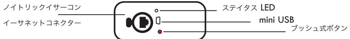
**Ethernet connector:** ネットワークとPoE (Power over Ethernet) へのアクセスを提供します。
