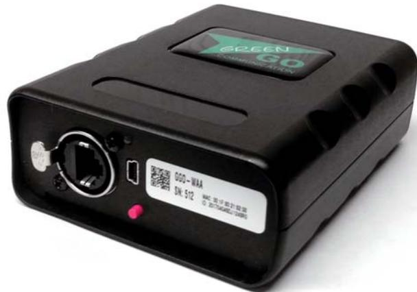
Green Go アンテナは、ワイヤレスベルトパックをイーサネット経由で他のGreen Goステーションに接続します。また、ベルトパック間の接続として機能するスタンドアローンでの設定可能です。
