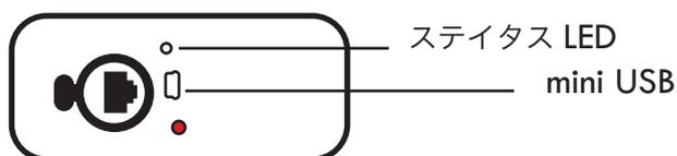
最大4つのベルトパックを1つのアンテナにペアリングし、usb Miniコネクタを介してアンテナに電力を供給すると、小さなスタンドアロンセットアップを作成できます。このセットアップは、ワイヤレスベルトパック間で利用可能なすべての通常の機能で動作します。スタンドアロンモードでは、他のネットワークデバイスが表示されないため、ステータスLEDが緑色/赤色に点滅します。
