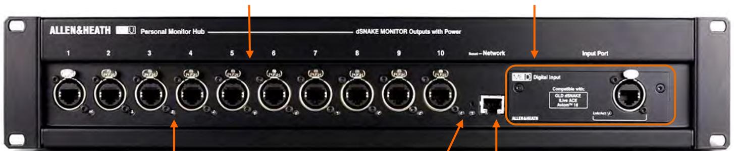
各ポートの隣にあるインジケータは、接続にリンクされていることを示すために黄色に点灯し、ネットワーク動作を表示するために点滅します。起動時またはエラーが検出されると、赤色に点灯します。
